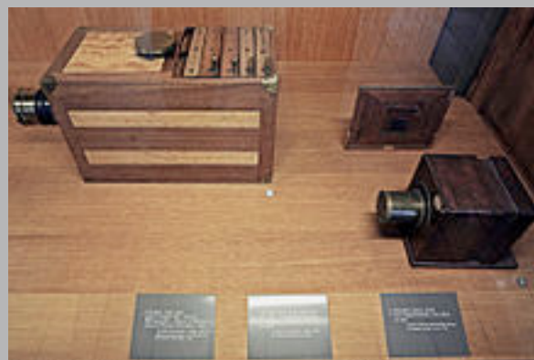
กล้องรูเข็ม (Camera Obscurae) และแผ่นทองแดงที่ใช้ในกระบวนการ Daguerreotype
